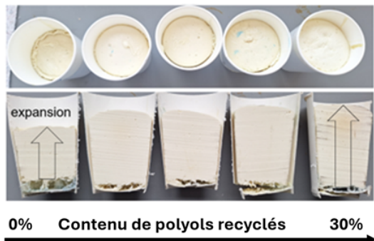
Figure 2 : Mousses PU obtenues par la société THIEME, formulées à partir de mélanges de polyols vierges et recyclés issus de la dégradation de leur mousses par le procédé développé par Materia Nova. Reproduit avec l'autorisation de THIEME.
